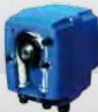
Pompa peristaltica con regolazione continua (da 0 a 100%) della portata. Tale regolazione si ottiene variando la velocità del motore 90 ÷ 260 V attraverso un potenziometro posto nella parte frontale della pompa. Disponibile con cavo di alimentazione a connettore estraibile, (lotti minimi 10 pezzi).
